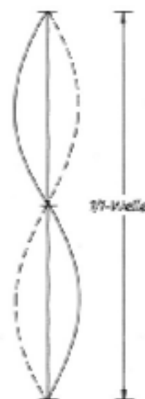
Abbildung 11: eine stehende Welle mit der Länge l = 1 \lambda
