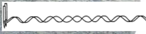
Abbildung 18: zwei Pfeifen, die unterschiedlich gestimmt sind, so dass eine Interferenzwelle und somit eine Schwebung entsteht
